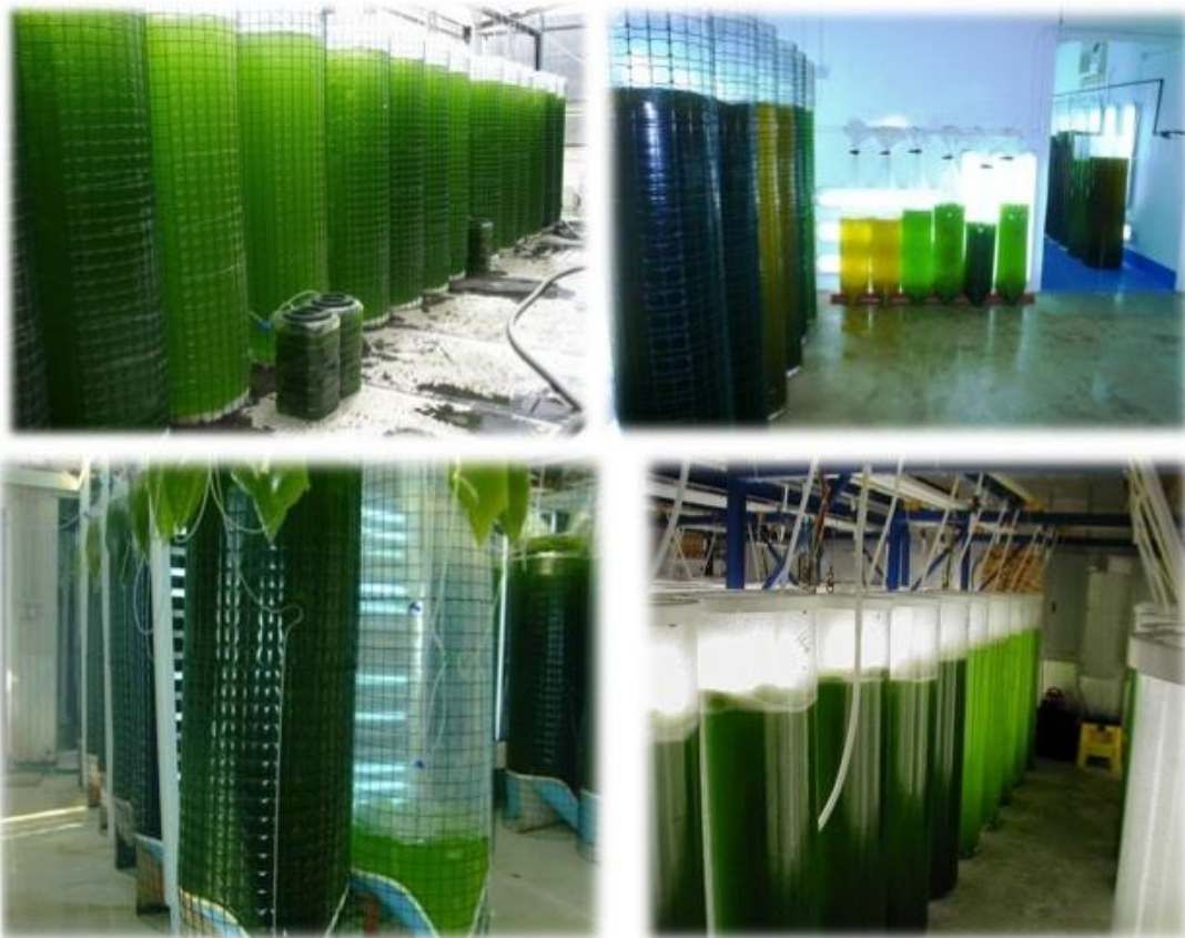
Σχήμα 22. Τελικοί όγκοι καλλιέργειας φυτοπλαγκτού σε κατάλληλα διαμορφωμένα κυλινδρικά δοχεία από πλαστικούς σάκους (50 - 200 L) που έχουν πάρει κυλινδρικό σχήμα τοποθετημένοι σε κατάλληλα διαμορφωμένο πλέγμα-σκελετό. Στη φωτογραφία κάτω δεξιά τα διαφανή δοχεία είναι κατασκευασμένα από πλέξιγκλάς.
