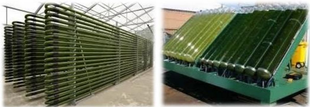
Σχήμα 23. Ειδικές κατασκευές τύπου «φωτοβιοαντιδραστήρες» (photobioreactors) για την τελική ανάπτυξη της φυτοπλαγκτονικής καλλιέργειας. Στους βιοαντιδραστήρες η καλλιέργεια κυκλοφορεί συνεχώς σε κλειστό κύκλωμα μέσα στους μικρής διαμέτρου σωλήνες οι οποίοι προσφέρουν πολύ μεγάλη επιφάνεια έκθεσης στο φως για καλύτερη φωτοσύνθεση. Αριστερά: βιοαντιδραστήρες τύπου σωλήνα. Δεξιά: βιοαντιδραστήρες τύπου πεπλατυσμένων δοχείων. Ο φωτισμός μπορεί να είναι και φυσικός.
