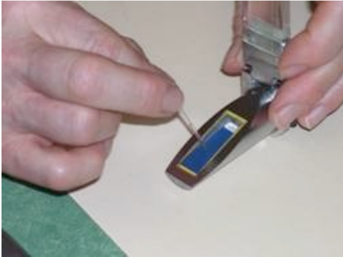
Εικόνα 2. Τοποθέτηση σταγόνας νερού στο διαθλασίμετρο.
