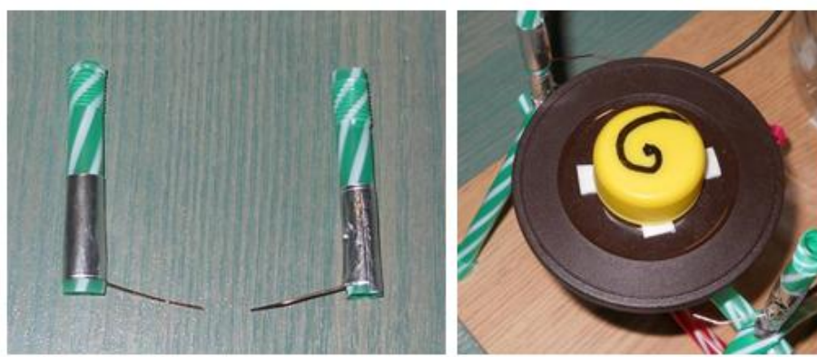
Εικόνα 13. α. (αριστερά) οι ακίδες του κινητήρα, β. (δεξιά) ο δίσκος στη βάση στήριξης.
