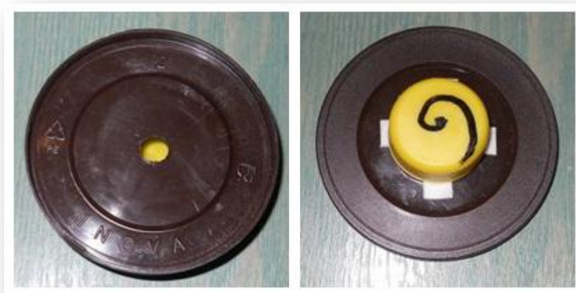
Εικόνα 12. Οι δύο πλευρές ενός δίσκου ηλεκτροστατικού κινητήρα τύπου “corona”.
