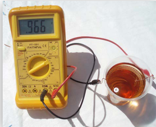
Εικόνα 4. Πειραματική διάταξη μέτρησης ηλεκτρικού στοιχείου (Διάταξη 1-1 με ένα σύρμα χαλκού και μία ξυλόβιδα). (Φωτογραφία Ε. Φανουράκη).
