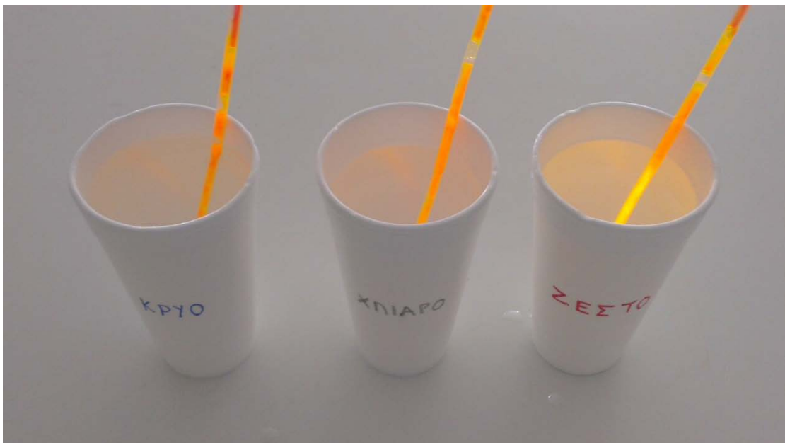
Εικόνα 4. Διαφορετικού χρώματος ράβδοι εμφανίζουν ακριβώς την ίδια συμπεριφορά όταν εμβαπτιστούν σε νερό διάφορων θερμοκρασιών. (Φωτογραφία της συγγραφέα).
