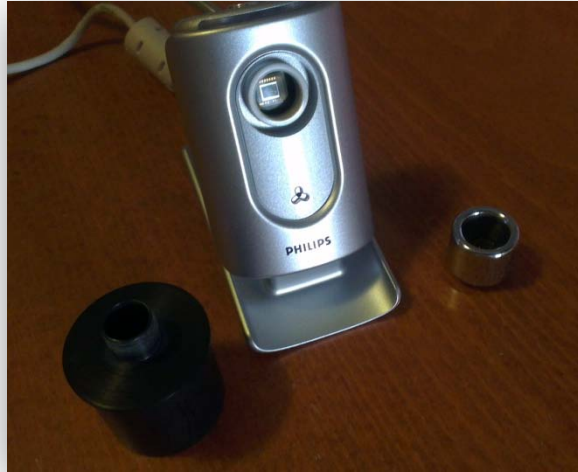
Εικόνα 2α (αριστερά): Το τηλεσκόπιο Meade ETX-70AT. 2β (δεξιά): Η τροποποιημένη web camera Philips ToUcam PRO II με αποσπασμένο το φακό της (δεξιά) και τον προσαρμογέα που επιτρέπει την τοποθέτησή της στο προσοφθάλμιο σύστημα του τηλεσκοπίου (αριστερά). Διακρίνεται ο αισθητήρας CCD. (Φωτογραφία των συγγραφέων).
