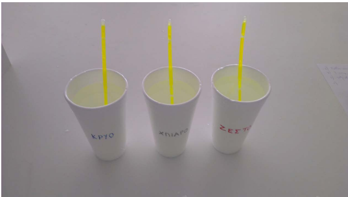
Εικόνα 2. Οι τρεις ράβδοι μόλις βυθίζονται στα ποτηράκια με νερό διαφορετικής θερμοκρασίας. (Φωτογραφία της συγγραφέα).
