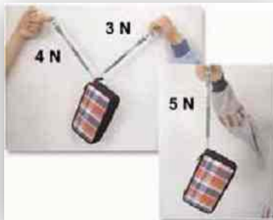
Εικόνα 1. Πειραματική “απόδειξη” του θεωρήματος με τη χρήση δυναμόμετρων (Αντωνίου κ.α., 2006, σ. 51).
