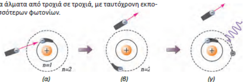
(α) Το άτομο του υδρογόνου στη θεμελιώδη κατάσταση πριν από την κρούση με το ηλεκτρόνιο. (β) Το άτομο σε διεγερμένη κατάσταση. (γ) Το άτομο επανέρχεται στη θεμελιώδη κατάσταση εκπέμποντας ένα φωτόνιο. Εικόνα 4.3-17
