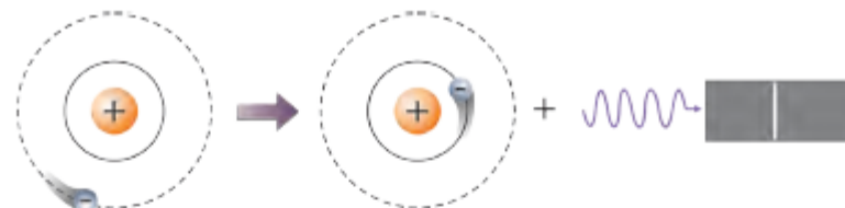
Ερμηνεία του φάσματος εκπομπής. Το άτομο εκπέμπει ένα φωτόνιο και μεταβαίνει στη θεμελιώδη κατάσταση. Η φωτεινή γραμμή αντιστοιχεί στο μήκος κύματος του φωτονίου που εκπέμπεται. Εικόνα 4.3-19
