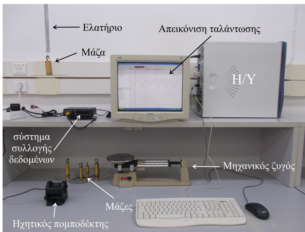
Σχήμα 9.4 Πειραματική διάταξη για τη μελέτη της απλής αρμονικής ταλάντωσης του συστήματος ελατηρίου-μάζας.
