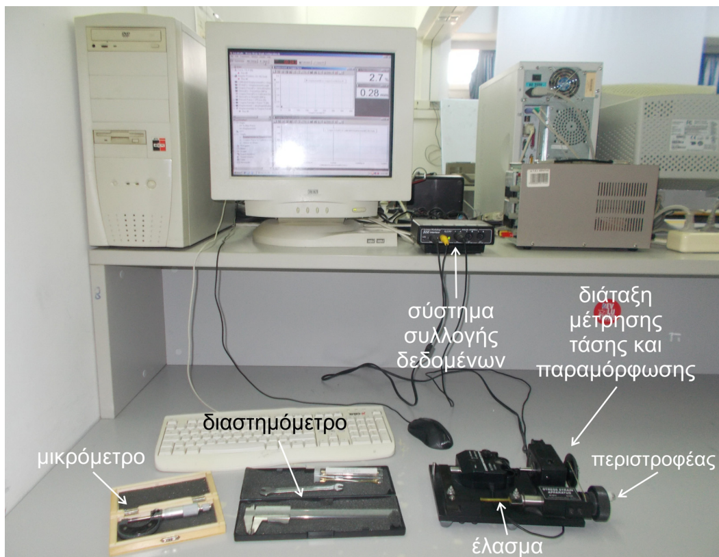
Σχήμα 8.15 Πειραματική εκπαιδευτική διάταξη για την καταγραφή της καμπύλης τάσης-παραμόρφωσης σε κατάλληλα διαμορφωμένα δοκίμια διαφόρων υλικών.
