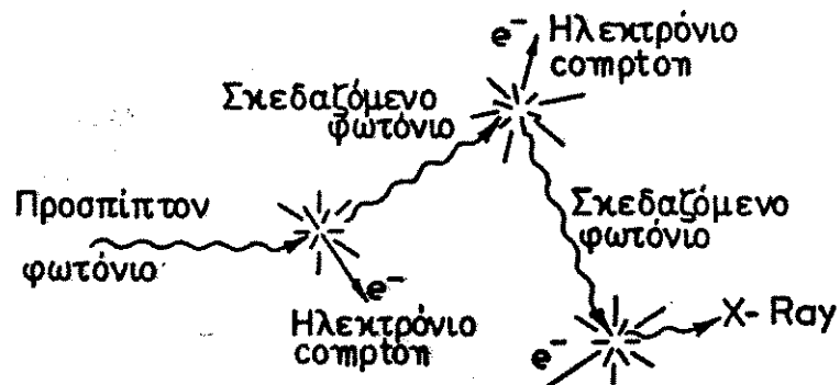
Σχήμα 12 : Πολλαπλές αλληλεπιδράσεις ενός φωτονίου κατά την πορεία του διά μέσου της ύλης.
