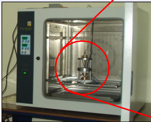
Alpha-N Analyser 10^{-6} - 10^7 Hz
