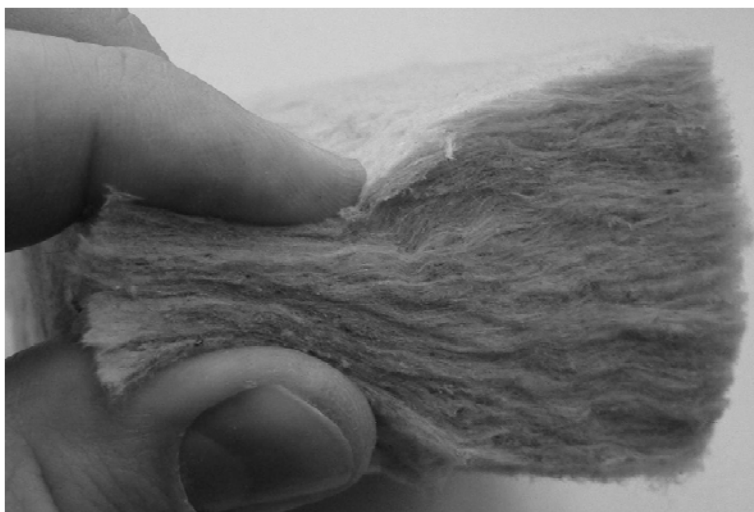
Χαρακτηριστική υφή ορυκτού πηλήματος. Από: http://en.wikipedia.org/wiki/File:Rockwool_4lbs_per_ft3_fibrex5.jpg
