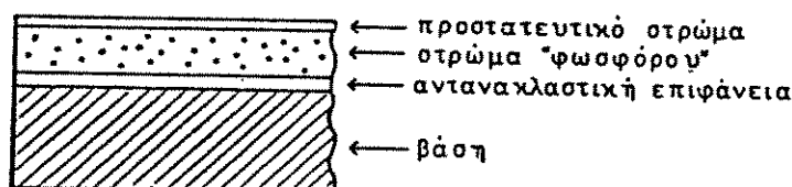
Σχήμα 13. Διατομή ενισχυτικής πινακίδας.
