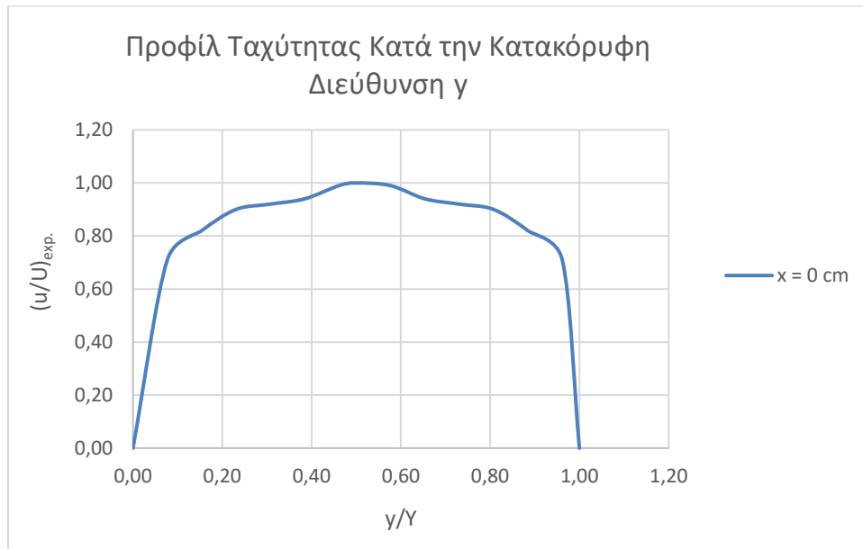
Σχήμα 2. Προφίλ ταχύτητας για τον αγωγό τετραγωνικής διατομής στη θέση x = 0 \text{ cm} .
