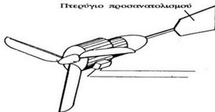
Σχήμα 3.5: Α/Κ με πτερύγιο προσανατολισμού.
