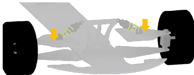
Σχήμα 7.9: Συναρμολόγηση των αμορτισέρ με τα ψαλίδια και το μπροστινό πλαίσιο
