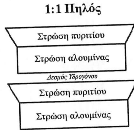
Σχήμα 5. Καολίνης με λόγο στις στρώσεις 4εδρων και 8εδρων 1:1. Επίστρωσεις διοξειδίου του πυριτίου και Αλουμίνιας τριοξειδίου αλουμινίου. Όταν ένα στρώμα καολίνη κείται επί ενός άηλου ξεχωριστού στρώματος καολίνη τα στρώματα εναλλασσόμενων τετράεδρων και οκτάεδρων στην ουσία είναι κολλημένα μεταξύ τους. Τα υδροξείδια στο οκταεδρικό στρώμα (κάτω μέρος στρώσης αλουμίνιας, βλ. και Σχ.6) βρίσκονται πλησίον του οξυγόνου της τετράεδρης στρώσης (κορυφή της στρώσης σίλικα), το οποίο επιτρέπει κοντινά στρώματα να ενώνονται με δεσμό υδρογόνου
