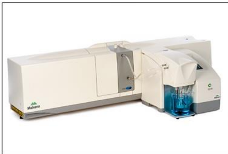
Εικόνα 2.5 Παράδειγμα συσκευής κοσκίνισης του λεπτόκοκκου κλάσματος με τη μέθοδο της σκέδασης.
