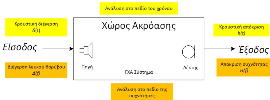
Σχήμα Α9: Μέτρηση απόκρισης ηλεκτροακουστικού συστήματος - χώρου ακρόασης με κατάλληλο σήμα διέγερσης, στα πεδία του χρόνου και της συχνότητας.
