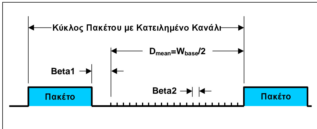
Σχ.2. 5. Βασική λειτουργία και παράμετροι του πρωτοκόλλου p-persistent CSMA (Beta1=Αδρανής Σχισμή, Beta2=Σχισμή Τυχαιότητας)
