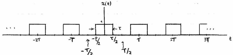
Λόγω της συμμετρίας γύρω από το 0 επιλέγουμε ως περίοδο ολοκλήρωσης  $T$  το διάστημα  $-\frac{T}{2} \leq t < \frac{T}{2}$ . Στο ίδιο αποτέλεσμα θα καταλήγαμε και για οποιαδήποτε άλλο διάστημα αν επιλέγαμε.
