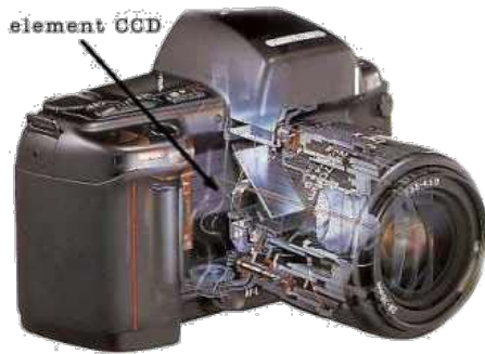
Εικόνα 29: Συστοιχία CCD ψηφιακής φωτογραφικής
