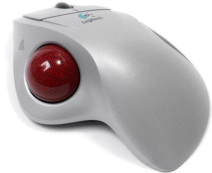
Ποντίκι με ενσωματωμένη ιχνόσφαιρα προϊόν trackman της εταιρίας Logitech
