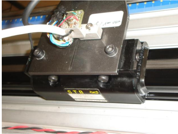
Εικόνα 5. Ολισθαίνων φορέας επί του κυλίνδρου
