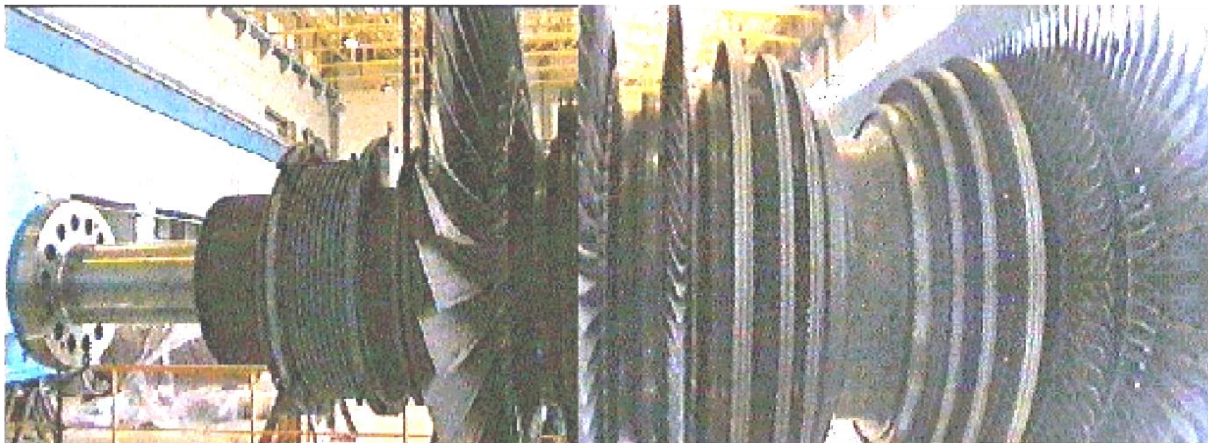
Σχ. 1.9 Άξονας του στροβίλου με τα στρεφόμενα πτερύγια.
