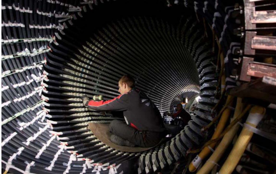
Κατασκευή στάτη σύγχρονης μηχανής [3]
