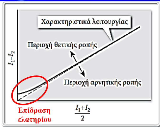
Χαρακτηριστικά λειτουργίας ενός αναλογικού-διαφορικού ηλεκτρονόμου.
