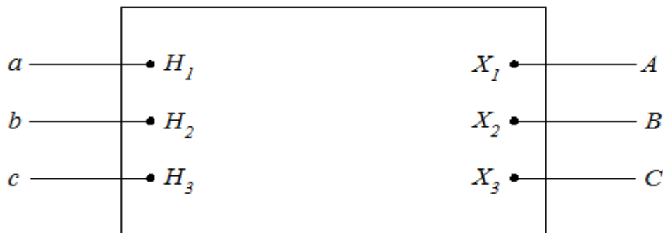
Εναλλακτικός τρόπος σύνδεσης γραμμών στους ακροδέκτες Υ/Δ μετασχηματιστή.
