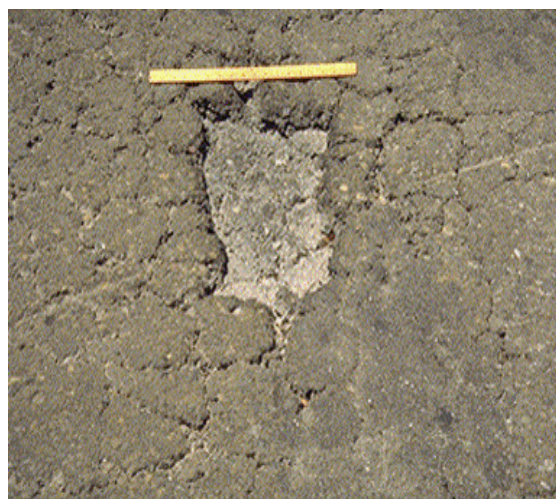
Εικόνα 4 Υψηλής έντασης ρωγμές τύπου αλιγάτορα
