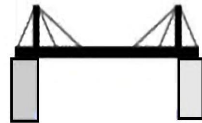
ΚΑΛΩΔΙΩΤΗ (Η ΑΝΑΡΤΗΜΕΝΗ) ΓΕΦΥΡΑ
