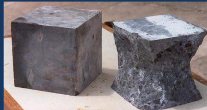
Video: Αστοχία Κυβικού Δοκιμίου
