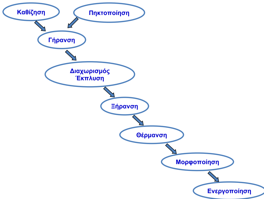
Σχήμα 12.1. Η συνθετική πορεία για την παραγωγή κάποιου φορέα ή μη στηριγμένου καταλύτη.
