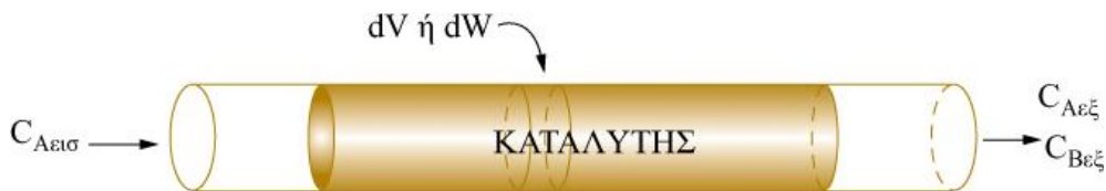
Σχήμα 2.3 Σχηματική αναπαράσταση ενός αυλωτού καταλυτικού αντιδραστήρα με σταθερή καταλυτική κλίνη.
