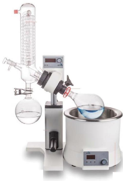
Σχήμα 13.4. Διάταξη για την εφαρμογή της τεχνικής του υγρού εμποτισμού.
