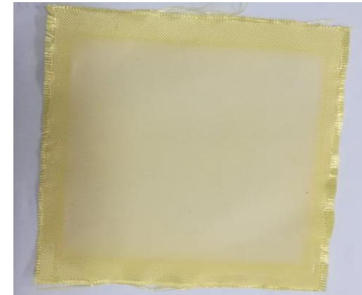
Δοκίμιο Kevlar® 20 x 20 cm με 10% διάλυμα του υδατοδιαλυτού πολυμερούς + 60% inorganic filler Material loading ( W_{\text{comp.}} / W_{\text{Kevlar}} ) : 10%
