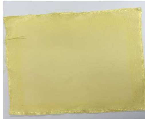
Δοκίμιο Kevlar® 20 x 20 cm με 10% διάλυμα του υδατοδιαλυτού πολυμερούς + 40% inorganic filler Material loading ( W_{\text{comp.}} / W_{\text{Kevlar}} ) : 10%
