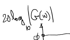
$$\lim_{\omega \rightarrow 0} |G(\omega)| = \frac{R}{R_1}, \quad \lim_{\omega \rightarrow +\infty} |G(\omega)| = 0$$
