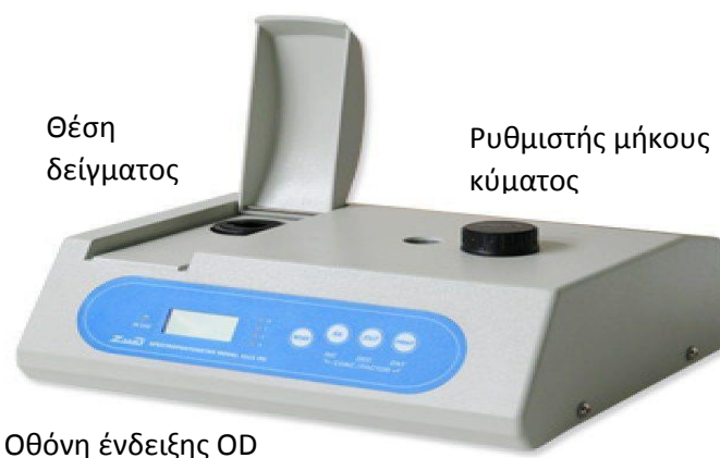
Εικόνα 5. Βασικά μέρη φασματοφωτομέτρου ( https://www.quirumed.com/ )
