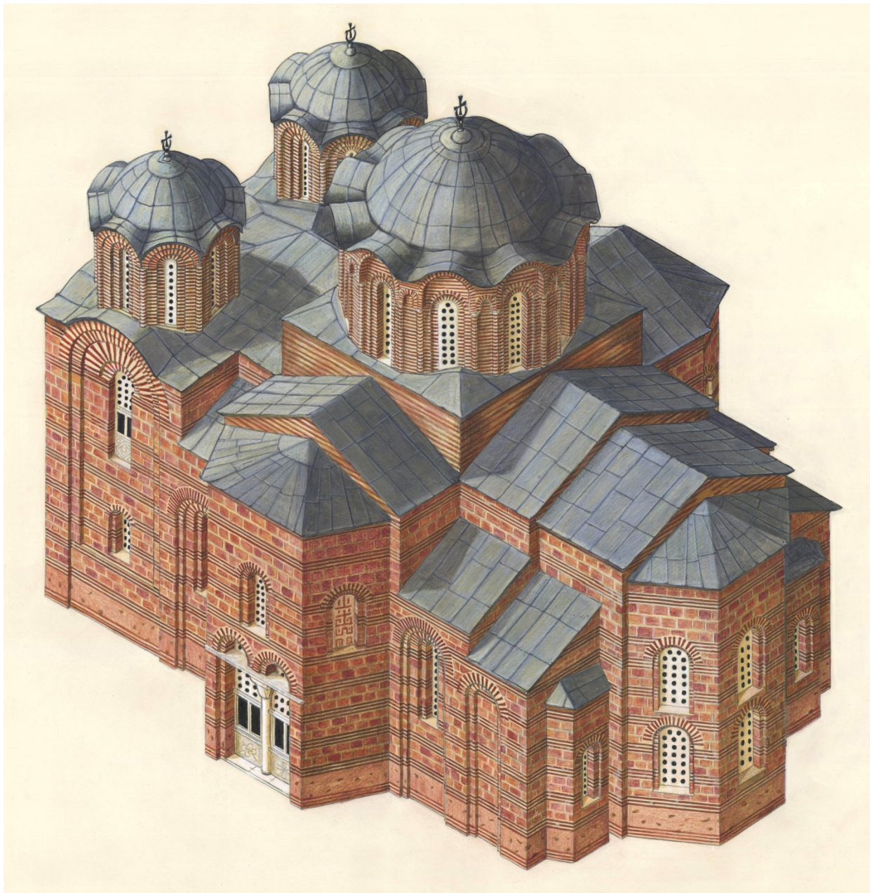
Μονή Βατοπεδίου, Καθολικό : αποξηλώσεις, τεκμηρίωση και αναπαράσταση της αρχικής μορφής
