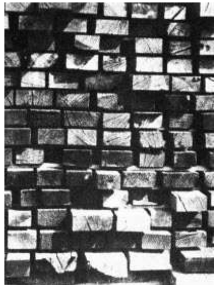
Τομή κορμού, όπου διακρίνονται χαρακτηριστικές συρρικνώσεις και παραμορφώσεις, που οφείλονται στη διεύθυνση των κοπτόμενων ετήσιων δακτυλίων.
