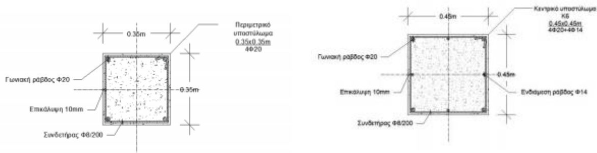
Σχήμα 2 Διατομή περιμετρικών (αριστερά) και κεντρικών (δεξιά) υποστυλωμάτων, τετραγωνικού σχήματος, διαστάσεων 0.35x0.35m και 0.45x0.45m αντίστοιχα.
