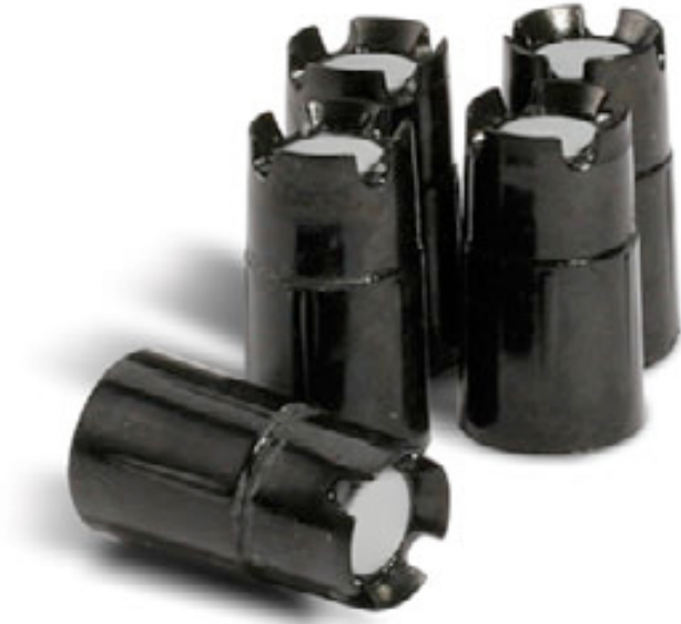
Σχήμα 2. Μεμβράνες τέφλον προσαρμοσμένες σε ειδικό πλαστικό καπάκι για γρήγορη προσαρμογή με βίδωμα στο άκρο του ηλεκτροδίου.
