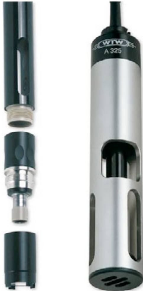
Σχήμα 4. Αριστερά φαίνεται ένα ηλεκτρόδιο οξυγόνου με το καπάκι της μεμβράνης έτοιμο να βιδωθεί (αφού πρώτα γεμίσει με ηλεκτρολύτη) στην απόληξη του ηλεκτροδίου το οποίο περιέχει την ασημένια κάθοδο και στο άκρο του τη χρυσή άνοδο. Δεξιά φαίνεται το συναρμολογημένο πλέον ηλεκτρόδιο με το προσαρμοσμένο ειδικό κάλυμα για να το προστατεύει όταν το βυθίζουμε σε βαθιά νερά στο πεδίο.
