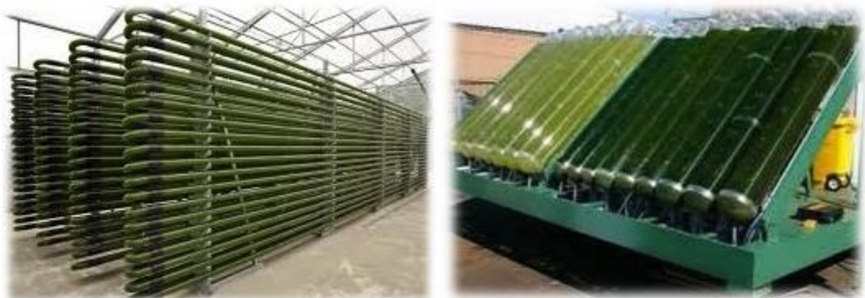
Σχήμα 23. Ειδικές κατασκευές τύπου «φωτοβιοαντιδραστήρες» (photobioreactors-PBR) για την τελική ανάπτυξη της φυτοπλαγκτονικής καλλιέργειας. Στους βιοαντιδραστήρες η καλλιέργεια κυκλοφορεί συνεχώς σε κλειστό κύκλωμα μέσα στους μικρής διαμέτρου σωλήνες οι οποίοι προσφέρουν πολύ μεγάλη επιφάνεια έκθεσης στο φως για καλύτερη φωτοσύνθεση. Αριστερά: βιοαντιδραστήρες τύπου σωλήνα. Δεξιά: βιοαντιδραστήρες τύπου πεπλατυσμένων δοχείων. Ο φωτισμός μπορεί να είναι και φυσικός.
