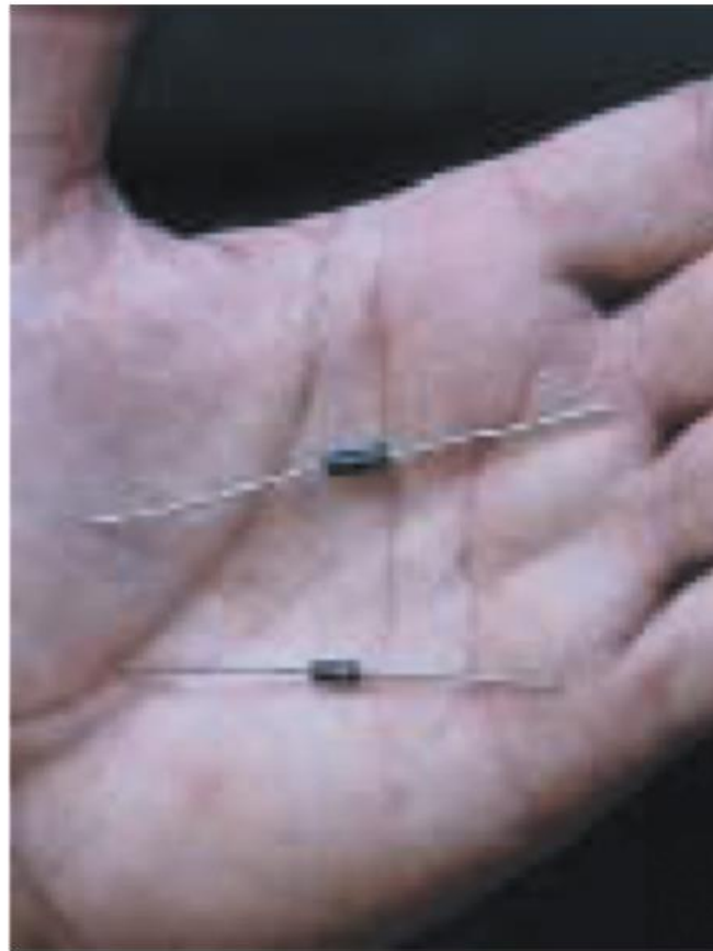
ΕΙΚΟΝΑ 23.10 Δίοδοι. Όπως υποδηλώνει το σύμβολο \rightarrow| , το ρεύμα κινείται κατά τη φορά του βέλους, άλλα όχι και αντίθετα.
