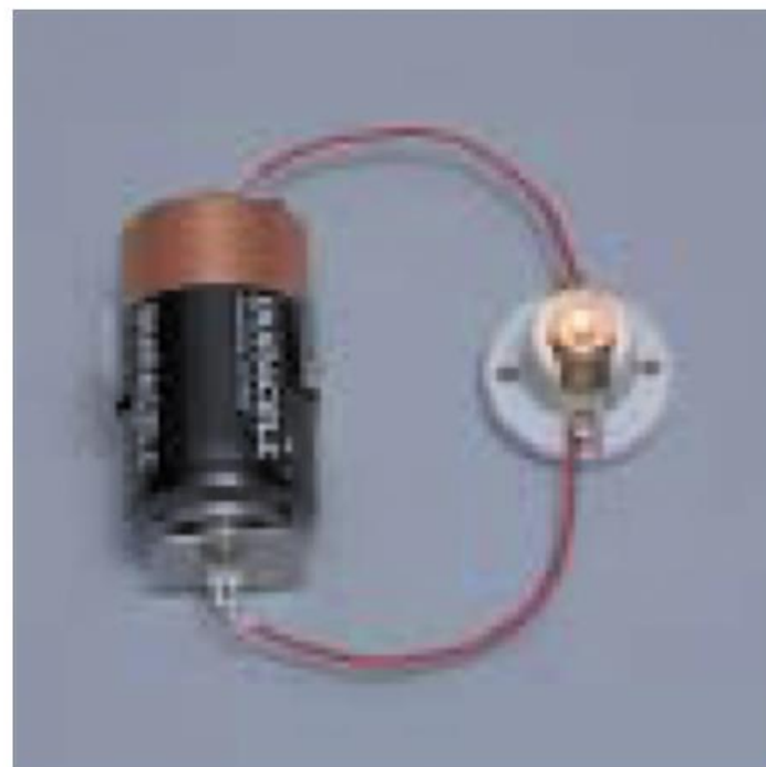
ΕΙΚΟΝΑ 23.2 Σε κάθε κουλόμπ φορτίου που διαρρέει ένα κύκλωμα το οποίο συνδέει τους ακροδέκτες αυτής της μπαταρίας 1,5V παρέχεται ενέργεια 1,5 J.
