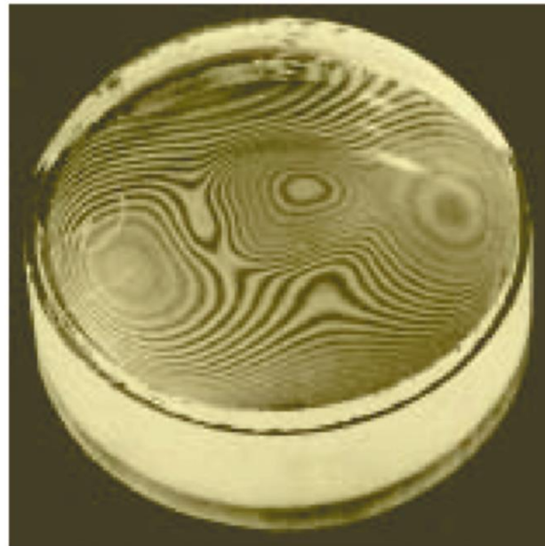
ΕΙΚΟΝΑ 29.24 Οπτικά επίπεδες πλάκες που χρησιμοποιούνται για τον έλεγχο της ομαλότητας επιφανειών.
