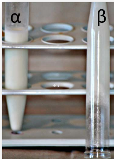
Εικόνα 5. Παρατηρούμε μετουσίωση μόνο στην αλβουμίνη (σωλήνας β). Φωτογραφία Μ. Ξαπλαντέρη.
