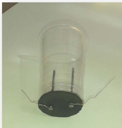
Εικόνα 1. Τοποθέτηση της τσιμούχας στον πάτο του ποτηριού. Φωτογραφία Π. Μουρούζης.
