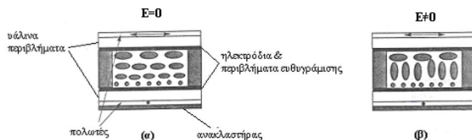
Σχήμα 46: Δομή κυψελίδας νηματικού υπό στρέψη ( twisted nematic cell ) [6].
