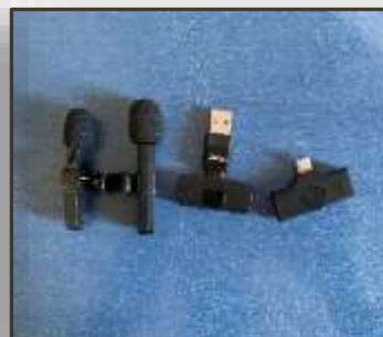
Εικόνα 145. Ψηφιακό μικρόφωνο (ψείρα) για μετατροπή φωνής σε γραφή (Ειδικό Λύκειο Κωφών & Βαρηκόων Αγίας Παρασκευής)
