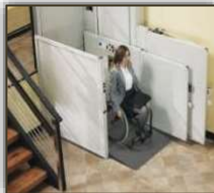
Εικόνα 90. Αναβατόριο κατακόρυφης κίνησης με πλατφόρμα σε χώρο σχολείου (Δημουλά, κ.ά., 2023)
