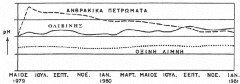
Σχήμα 5. Επίδραση ολιβίνη και ανθρακικών πετρωμάτων στο pH των όξινων λιμνών (από Handols Taljsten 1983 κατά Φύλιππίδη 1996).
