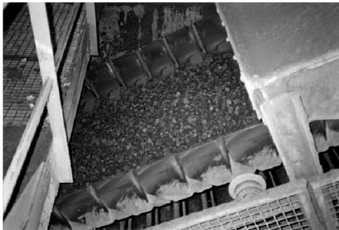
Το clinker τη στιγμή που αφήνει τον κεκλιμένο διάδρομο μεταφορά και ψύξης για να αποθεθεί στο χώρο αποθήκευσης (εικόνα: ©Dylan Moore 2011, http://www.cementkilns.co.uk/ck_clinker.html )
