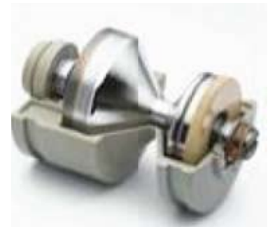
Σχήμα 49: Λυχνία παραγωγής ακτίνων-Χ αξονικού τομογράφου
