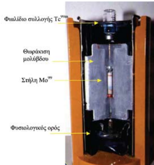
Σχήμα 71: Τομή γεννήτριας παραγωγής ^{99\text{m}}\text{Tc}
