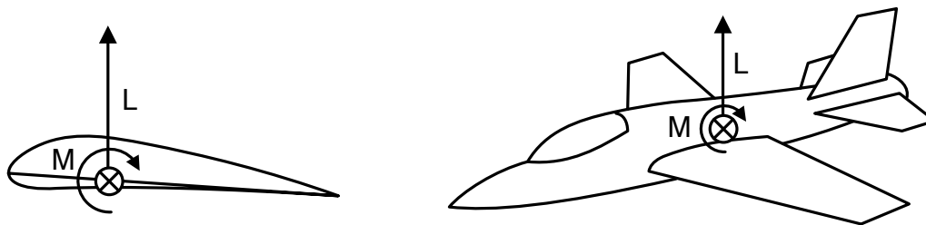
Σχήμα 6.6: Αεροδυναμικό κέντρο αεροτομής και ουδέτερο σημείο αεροσκάφους.
