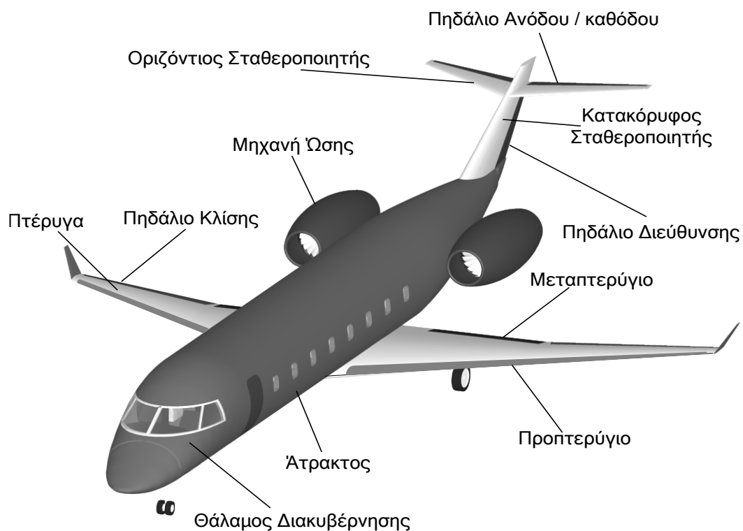
Σχήμα 4.1: Κύρια μέρη και επιφάνειες ελέγχου συμβατικού αεροσκάφους.
