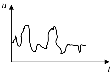
Σχήμα 4.16: Η τύρβη χαρακτηρίζεται από τυχαίες διακυμάνσεις των ροϊκών μεγεθών.
