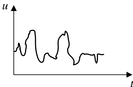
Σχήμα 4.16: Η τύρβη χαρακτηρίζεται από τυχαίες διακυμάνσεις των ροϊκών μεγεθών.
